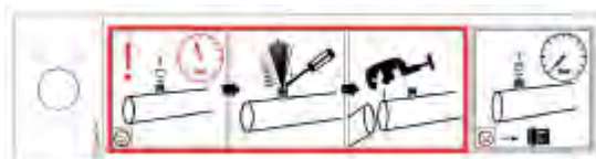
940 - Wskazówka ostrzegawcza - „Wypełnienie na czas transportu” przy zaworze Schradera
